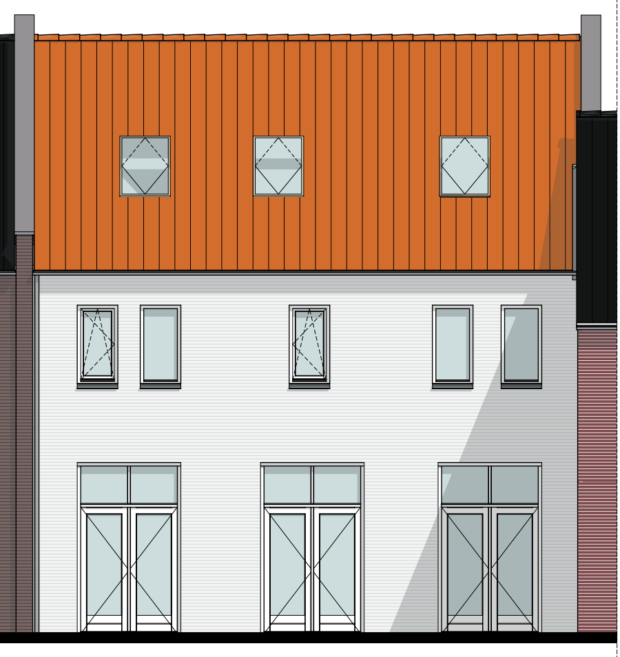
Achtergevel 1:100 1.B.X.20A Fakro tuimelvenster 94 x 140 cm wit afgelakt (FTW-V 09) - positie A 1.B.X.20A Fakro tuimelvenster 94 x 140 cm wit afgelakt (FTW-V 09) - positie B 1.B.X.22 Vergroten standaard dakraam 94 x 140 cm (FTW-V 09) 1.A.0.05 Kozijn met vast glas in achtergevel uitvoeren in dubbel openslaande deuren 1.A.0.06 Kozijn met enkele deur en raam in achtergevel uitvoeren in openslaande deuren
